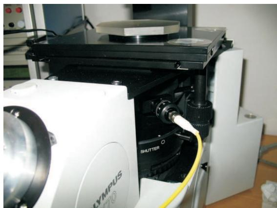
Laserový mikroskopický adaptér umístěný
