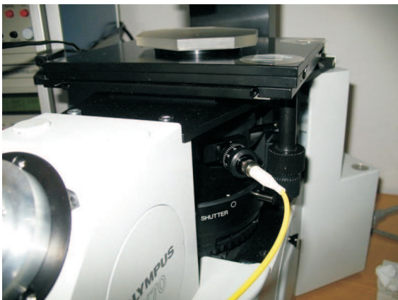
Laser-Mikroskop- Adapter ist im Revolver-Objektivkopf, an dem z.B. für Nomarski DIC Slider vorgesehenen Platz, angebracht
